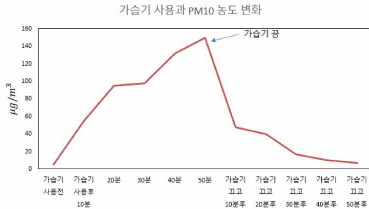
[그림 7] 가습기 사용에 따른 PM10 농도의 시계열 ( \mu\text{g}/\text{m}^3 ). 가습기 사용으로 PM10 농도가 증가하고, 사용을 멈춘 후에는 농도가 급격히 감소하였다. 이 결과는 2017년 7월 15일 방문이 닫힌 방에서 1회 실험에서 얻었다.
